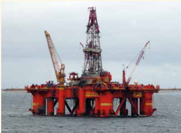
Plataforma de petróleo em alto mar, modo mais usado no Brasil para a retirada de petróleo e gás natural.
