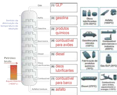
Destilação fracionada do petróleo e seus produtos.
