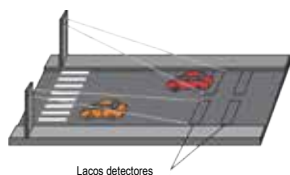
Esquema representando o funcionamento de um radar de trânsito.
