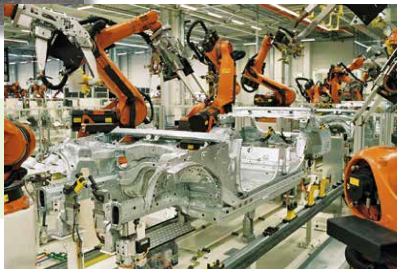
Soldagem por pontos de carrocerias com robôs em indústria automobilística, Alemanha, atualmente.
