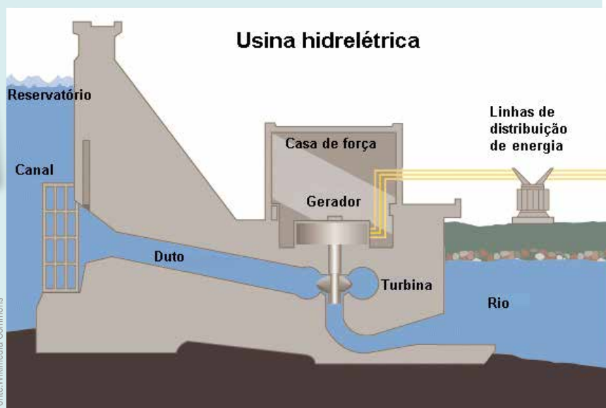
Esquema de funcionamento de uma Usina Hidrelétrica.
