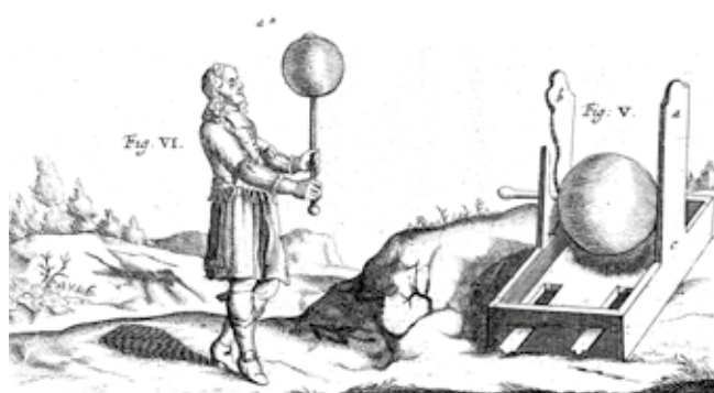
A máquina eletrostática de Otto von Guericke, que soltava faíscas entre as esferas.
